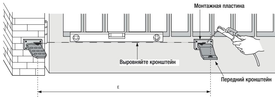
Закройте ворота и прикрепите монтажную пластину к створке, убедившись в том, что передний кронштейн расположен на одной горизонтальной оси с задним кронштейном, а также соблюдая расстояние E.
