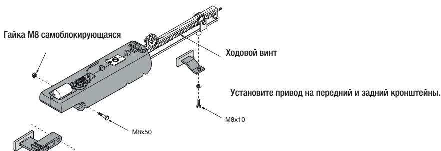
Важное примечание: рекомендуется смазать (жирной смазкой) ходовой винт и втулку до установки привода.
