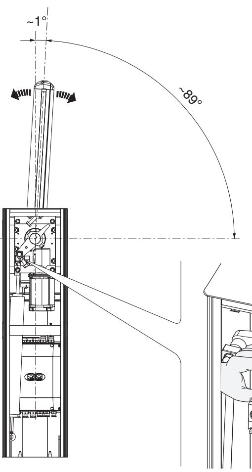
Чтобы откорректировать вертикальное положение (=открывания), опустите стрелу, откройте смотровую дверцу и поверните механический упор открывания по часовой стрелке или против нее, затем зафиксируйте упор с помощью контргайки.
