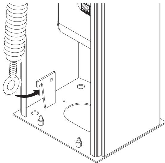
Чтобы увеличить или уменьшить тяговое усилие, поверните балансировочную пружину вручную таким образом, чтобы стрела остановилась под углом в 45°.
