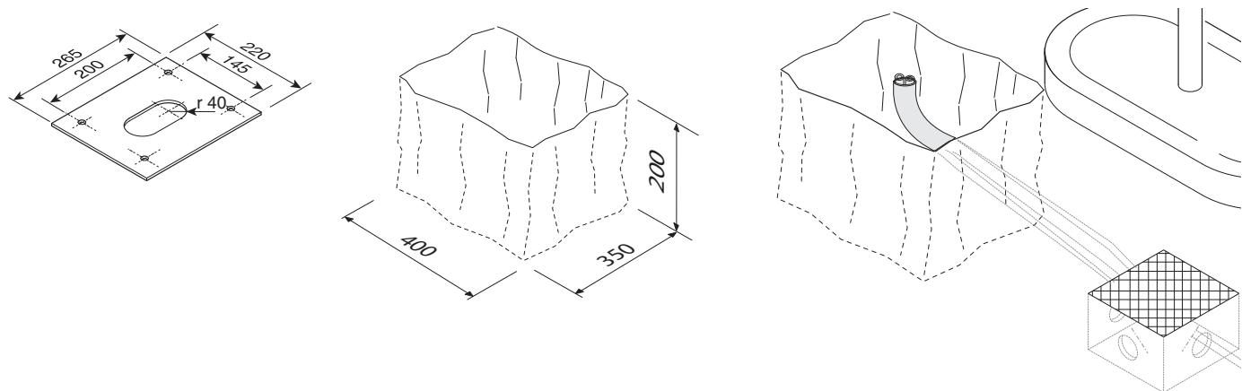
Подготовьте опалубку большего, чем монтажное основание, размера и установите ее в яму.
