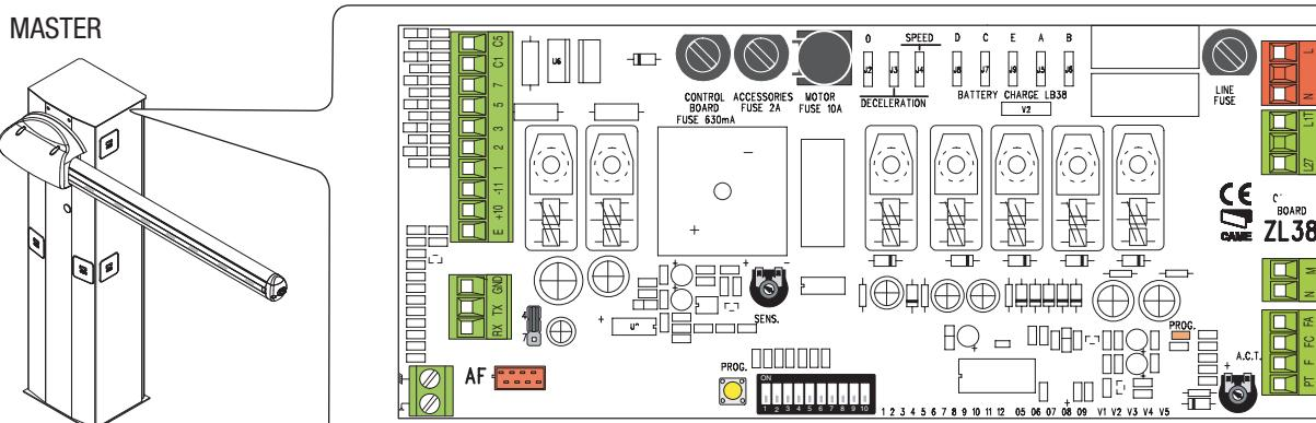
На ВЕДОМОМ блоке управления подключите электропитание к контактам L-N, сигнальную лампу к 10-E; установите DIP 7 в положение ON и отрегулируйте скорость движения и замедления, как на блоке управления ВЕДУЩЕГО шлагбаума.
