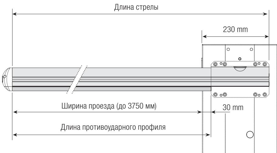
Установите кожух крепления стрелы к пластине приводного вала с помощью одного винта, не затягивая его.
