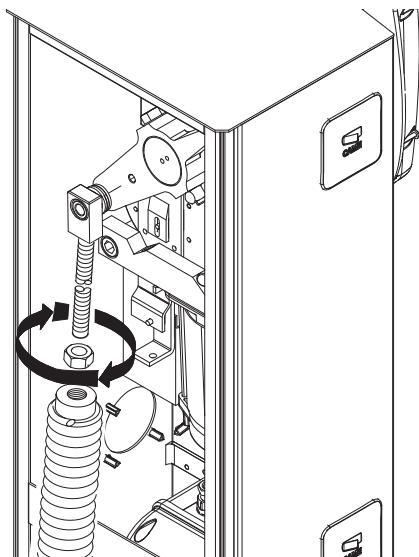
Привинтите пружину к анкерному стержню, прикрепленному к рычагу передачи.
