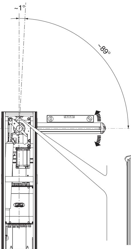
Чтобы откорректировать горизонтальное положение (=закрывания), поднимите стрелу, отрегулируйте механический упор закрывания и зафиксируйте его с помощью контргайки.
