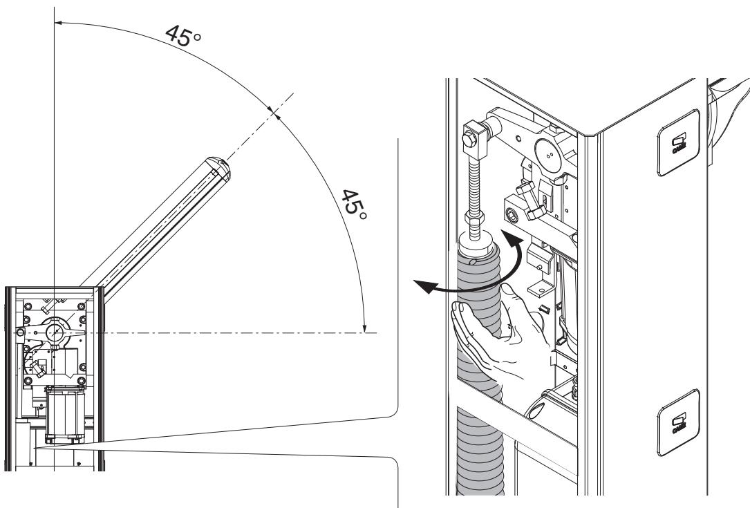
Затяните гайку тяги и заблокируйте привод. Заблокируйте привод.
