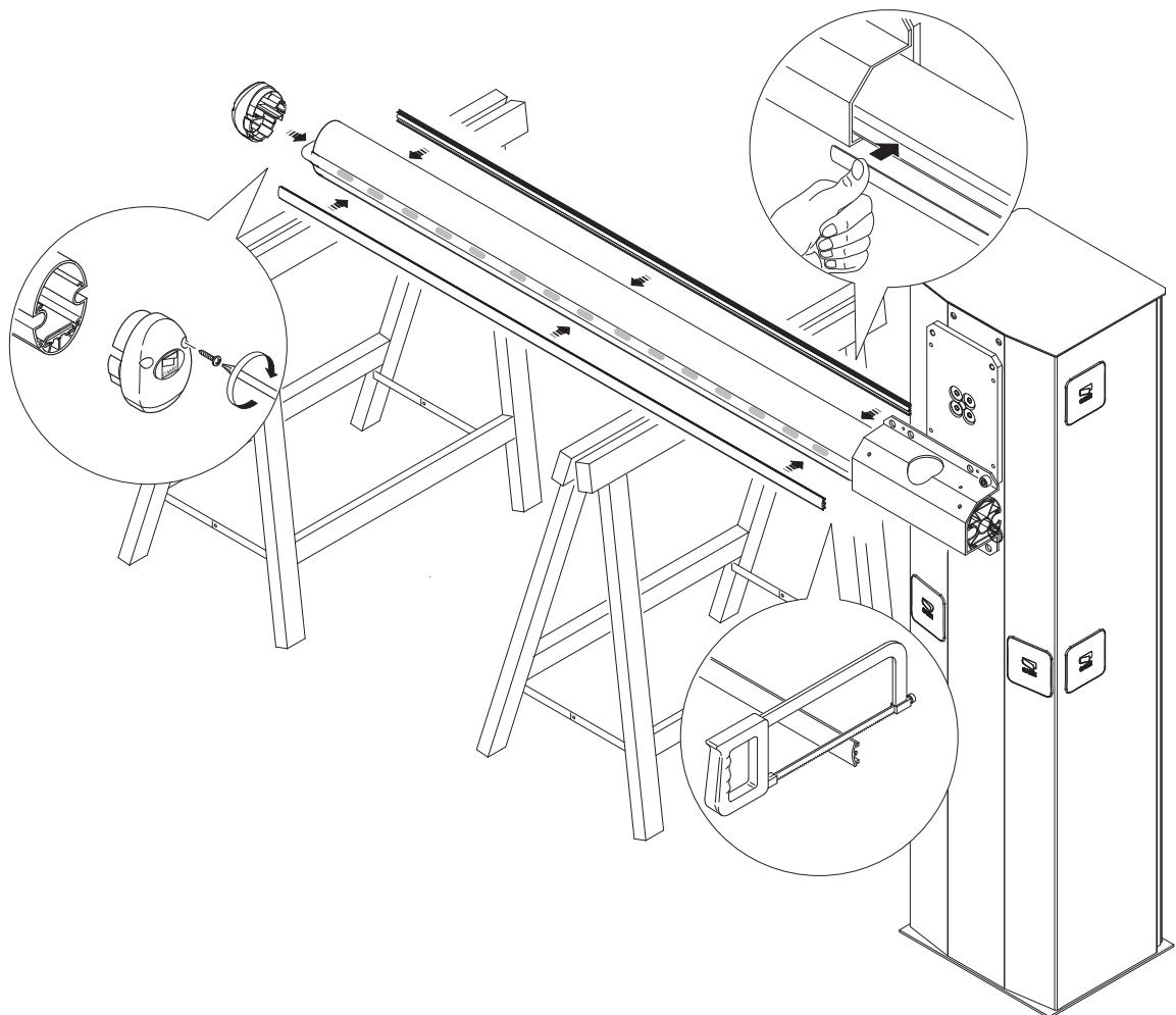
Вставьте и зафиксируйте на кожухе защитную крышку.
