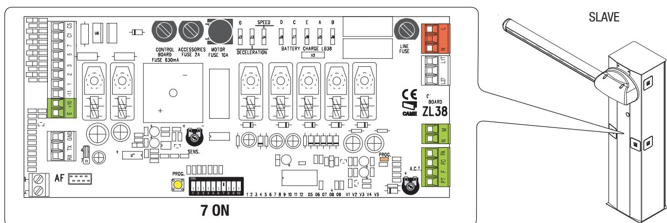
Подключите блоки управления так, как показано на рисунке, используя контакты RX-TX-GND.
