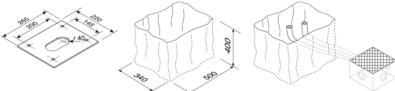
Подготовьте опалубку большего, чем монтажное основание, размера и установите ее в яму.
