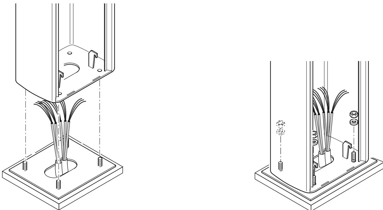
Заденьте крепление стрелы и кронштейн крепления стрелы на опорной пластине с помощью винта. Не затягивайте его, чтобы было проще установить стрелу.
