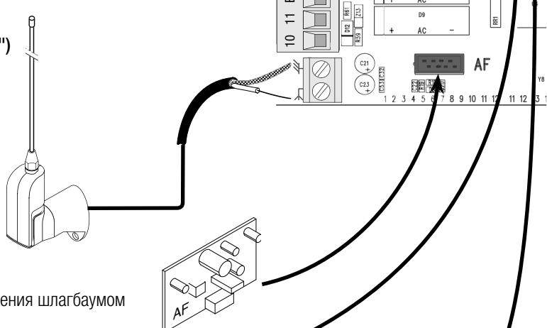
Вставьте плату AF для управления шлагбаумом с помощью брелока-передатчика.
