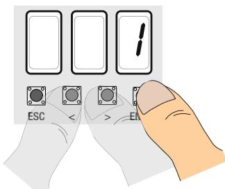
3. ... в течение нескольких секунд будет мигать свободное число от 1 до 25; оно будет присвоено пользователю после подачи команды с помощью брелока-передатчика или другого устройства управления (считывателя карт, проксимити-считывателя или кодонаборной клавиатуры).
