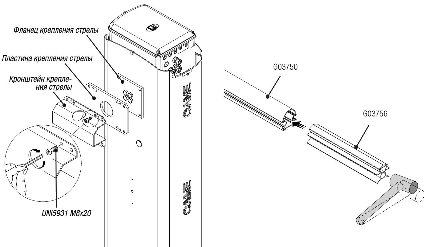
Вставьте стрелу в кронштейн крепления и зафиксируйте ее с помощью болтов.
